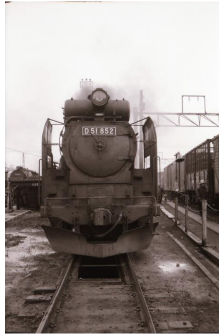
上部が直線状の変形煙室扉
