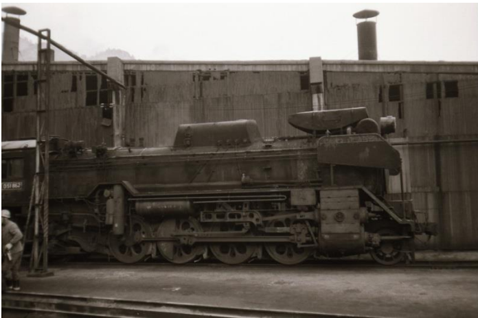
D51862 の特殊形状のドーム、放熱管も下の例と比較すると違いが判る。
